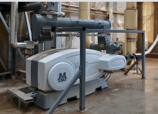
Le MDF s'impose comme une alternative de plus en plus attractive aux panneaux de particules au bois brut. C.F. Nielsen a développé une solution pour traiter les poussières de MDF.
